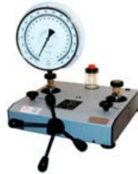
**Comparatore di pressione idraulica
